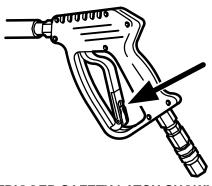
TRIGGER SAFETY LATCH SHOWN DISENGAGED
